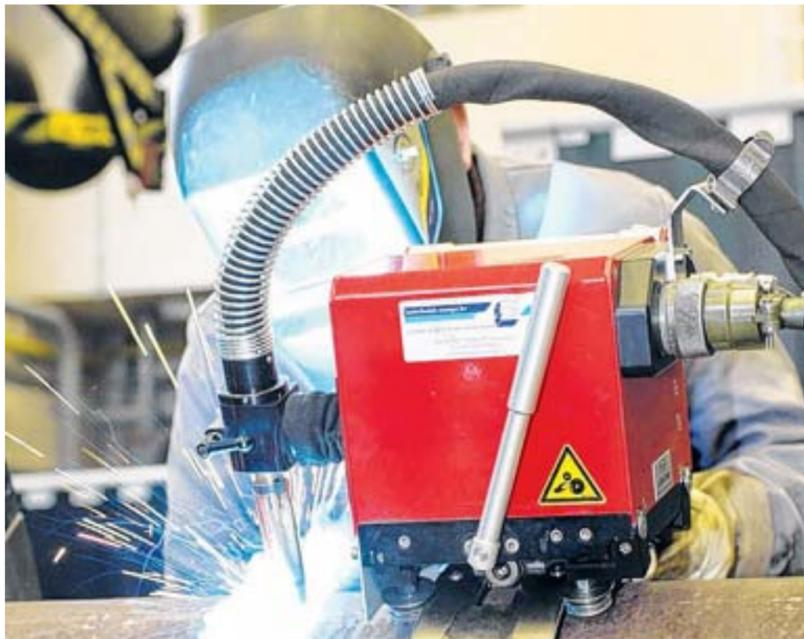
Mit dieser Versuchs-Rundschweißnaht werden Stahlrohre verbunden.
